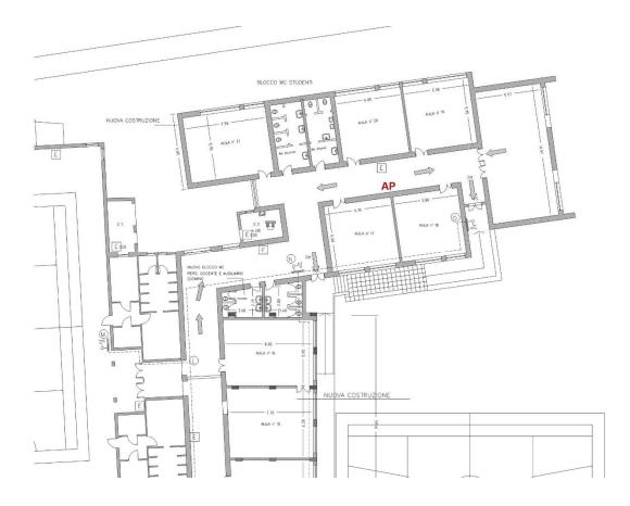
Al piano terra si prevede il collaudo con eventuale riqualificazione del cavo esistente con uno di categoria Cat6 e la fornitura di 1 nuovo Access Point Gigabit nel punto indicato in piantina. La connessione ad Internet viene fornita dalla Scuola adiacente.
